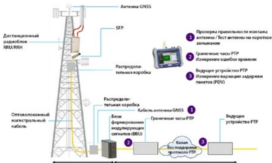
Пример точек Измерения синхронизации и шкал времени
